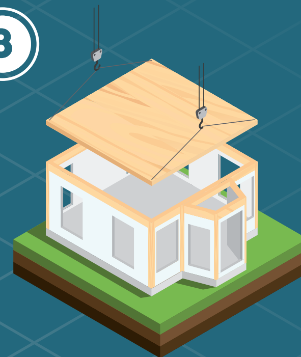
Posa solai o copertura
